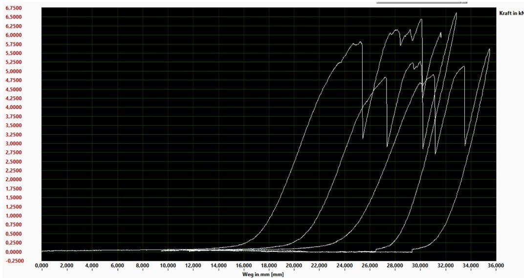
**Ergebnis: Bruchkraft min.4,75 kN, MBK von 9,75kN nicht erreicht.**
