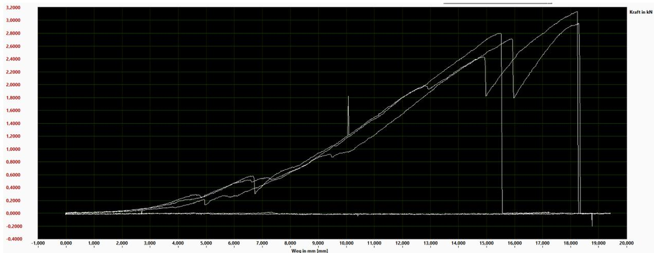
**Ergebnis: Bruch des Drahtseils innerhalb der Klemme min. 2,4kN, MBK des Drahtseils von 3,04kN nicht erreicht. Nutzlast max. 48kg bei fünffachem Sicherheitsfaktor**
