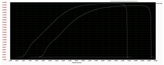
Ergebnis: Zweimal Bruch des Gewindes bei min. 40kN,
