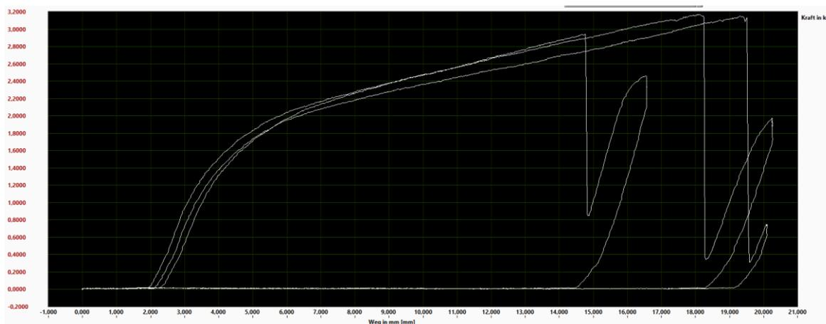
**Ergebnis: S Haken biegt bei 1,4kN auf. Max. Nutzlast 28kg**
