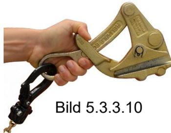
Bild 5.3.3.10: Den Seilgreifer am Öffnungshebel gegen den Federdruck öffnen.
