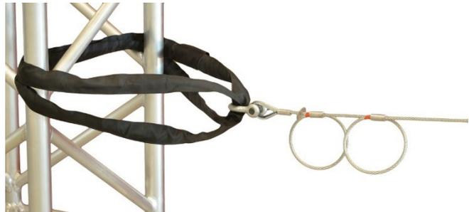
Schritt 1: *Seilkomponente* an geeigneten Anschlagpunkt anschlagen, siehe Bild 5.3.3.1 mit Traversenabhängung bzw. Bild 5.3.3.2 mit Softsteel WLL 2t und vollständig dralfrei ausrollen.
