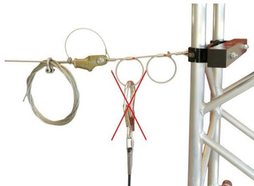
Bild 5.5.1.2: Nicht an einer Schlaufe eines Dämpfungselementes anschlagen.
