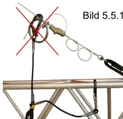
Bild 5.5.1.7: Nicht in Bereiche mit einem Winkel  $> 3^\circ$  von der Horizontalen anschlagen
