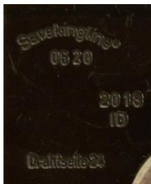
Bild 5.3.5.4: Kennzeichnung der Umlenkrolle: Savekingline®; Herstellungsjahr; Chargen Nr. Rolle; Drahtseile24 GmbH; Herstellerkennzeichen „ID“ EN 795:2012
