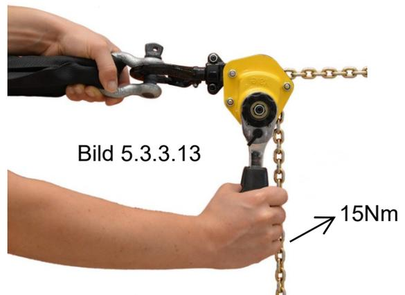
Bild 5.3.3.13: Die Savekingline® mit dem Hebelzug mit max. 15Nm am Hebel spannen.
