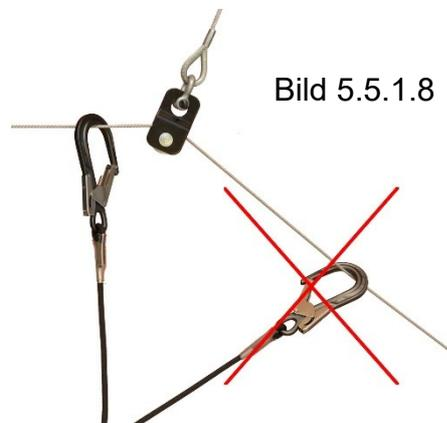
Bild 5.5.1.8: Nicht in Bereiche mit einem Winkel  $> 3^\circ$  von der Horizontalen anschlagen
