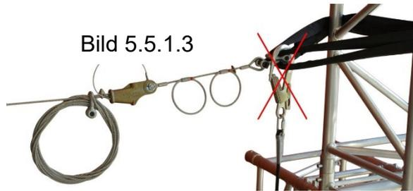
Bild 5.5.1.3: Nicht an den Komponenten der Anschlagpunkte anschlagen.
