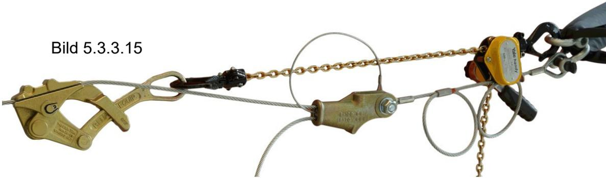
Schritt 6: Das Seilverschluss wird so stramm wie möglich in den nicht gespannten Teil der Savekingline® gesetzt (Bild 5.3.3.15).
