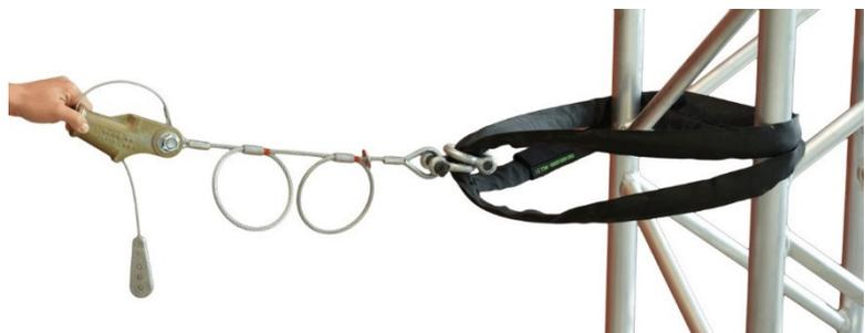
Schritt 2: *Seilschlosskomponente* an geeigneten Anschlagpunkt anschlagen, siehe Bild 5.3.3.3 mit Traversenabhängung bzw. Bild 5.3.3.4 mit Softsteel WLL 2t.
