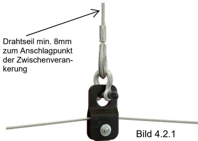
Bild 4.2.1: Von Drahtseile24 GmbH gekennzeichnete Umlenkrolle zur Feldbegrenzung. Andere Umlenkrollen der Savekingline® sind nicht zugelassen. Angeschlagen mit Schäkel gemäß DIN EN 13889 geschweißt mit Nenngröße 2,0t
