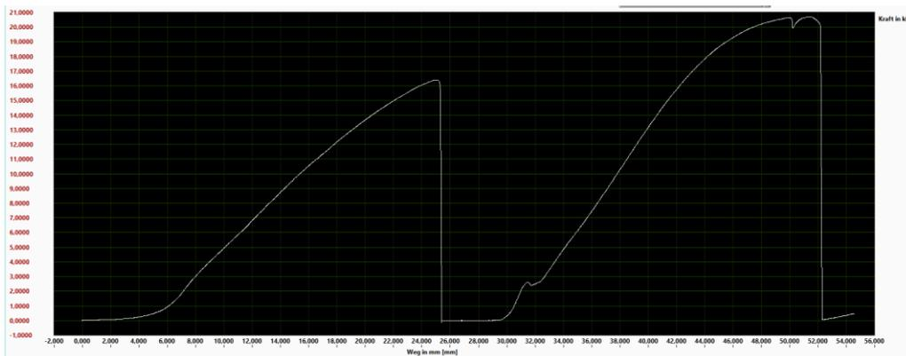
**Ergebnis: Bruchkraft V25: 16,3kN Seilbruch, V26: 20,69kN Seilbruch. Gutes Ergebnis.**
