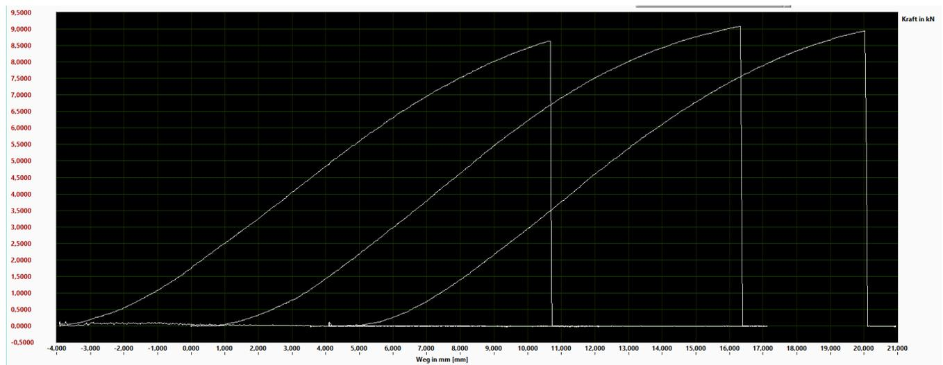
**Ergebnis: Bruchlast min. bei 8,5kN, MBK von 6,39kN überschritten. Seilbruch an Pressklemme, Fitting unbeschädigt.**
