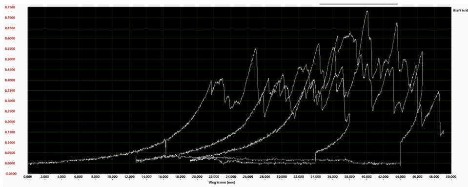
**Ergebnis: Durch Eiformklemme 5mm rutschendes Drahtseil bei 0,39kN, max. Nutzlast bei 3-fachem Sicherheitsfaktor für Eiformklemme 5mm = 40kg.**
