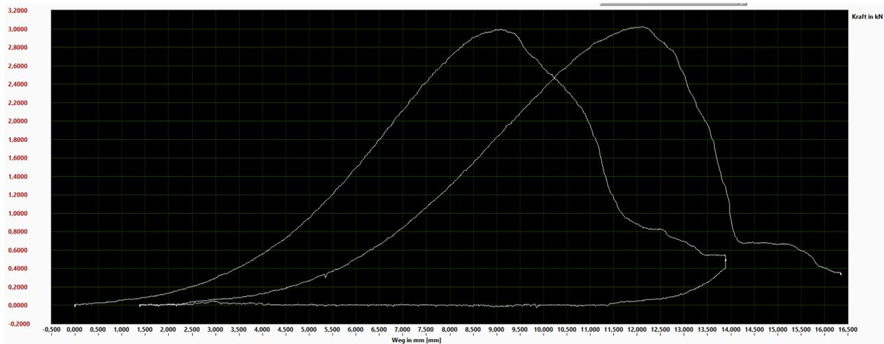
**Ergebnis: Schraube aus Holz gezogen bei 2,9kN**
