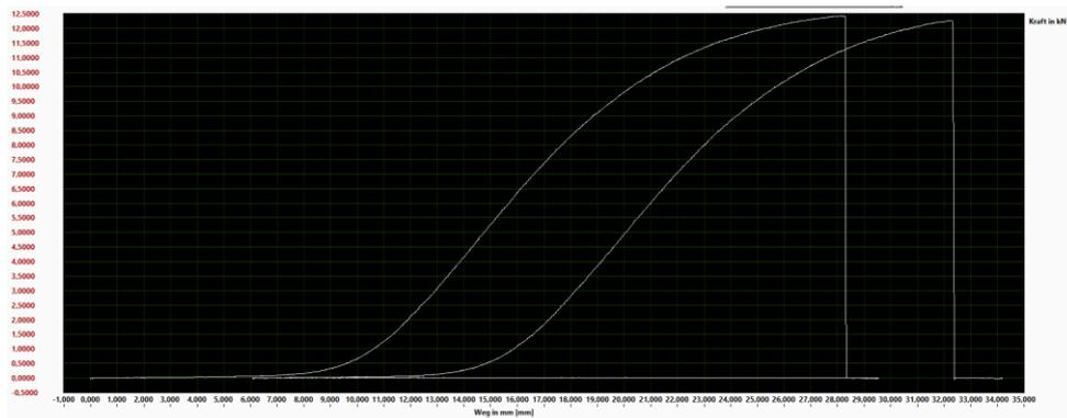
**Ergebnis: Kleinste Bruchkraft 12,1kN. Zweimal Seilabriss hinter Klemme.**
