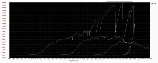
Ergebnis: Kleinste Bruchkraft ca. 4,0kN = ca. 400kg, Nutzlast max. 100kg bei Sicherheitsfaktor 4
