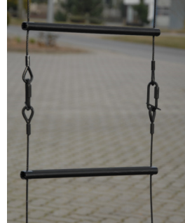
Bild 7: Anreihung einer zweiten Seileiter.
