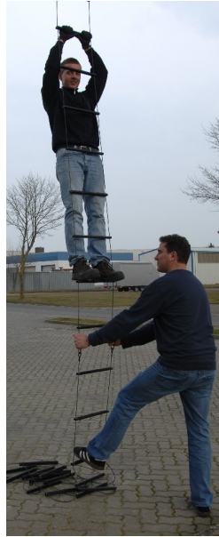
Bild 2: Seilleiter gegen Pendeln gesichert.
