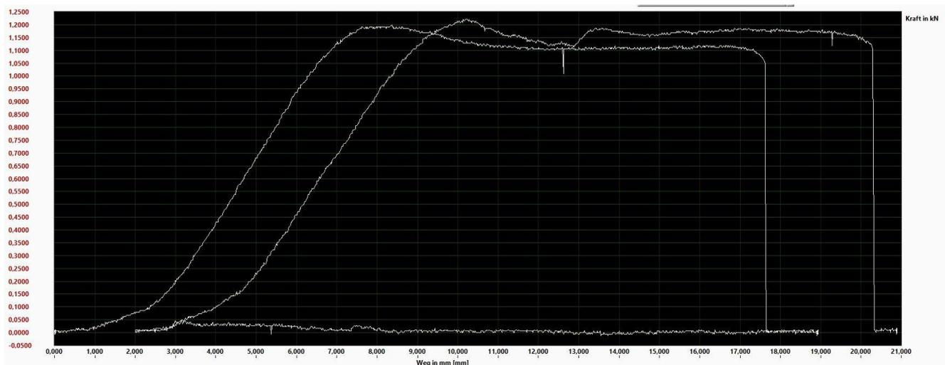
**Ergebnis: Aufbiegen des Hakens bei min. 0,9kN, Nutzlast max. 18kg bei fünffachem Sicherheitsfaktor**
