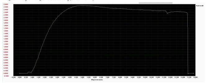
Ergebnis: Öffnung eines Hakens am Spannschloss bei 2kN. Max. Nutzlast 40kg bei fünffachem Sicherheitsfaktor.
