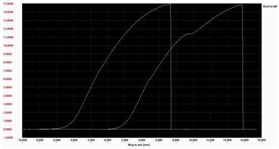
Ergebnis: Zweimal Seilbruch innerhalb der Pressklemme bei 14,8kN. MBK in Höhe von 13,2kN überschritten. Nutzlast bei fünffachem Sicherheitsfaktor: 265kg.
