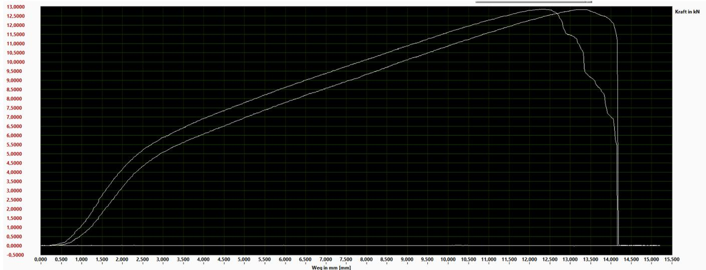
**Ergebnis: Bruch bei min. 12,5kN. Drehwirbelbolzen abgerissen.**
