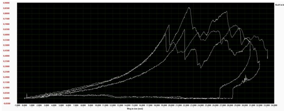
**Ergebnis:** Durch Eiformklemme 6mm rutschendes Drahtseil bei 0,6kN, max. Nutzlast bei 3-fachem Sicherheitsfaktor für Eiformklemme 6mm = 20kg.
