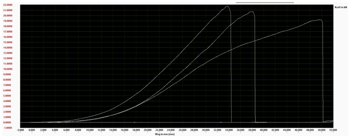
**Ergebnis: Bruchlast bei min. 19kN, MBK von 38,51kN nicht überschritten. Drahtseil in der Seilklemme durchtrennt. Im Kraftbereich von ca. 10kN tritt eine Verformung der Seilspannklemme ein, die sich nicht negativ auf die zwei weiteren Versuche auswirkt.**
