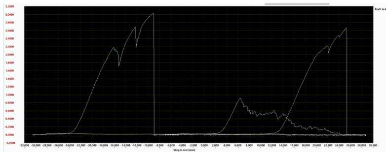
**Ergebnis: Kleinste Bruchkraft ca. 0,9kN = ca. 91kg, Nutzlast max. 23kg bei Sicherheitsfaktor 4**
