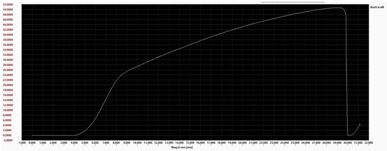
**Ergebnis: Beginn der plastischen Verformung bei ca. 22kN, Gewindeabriss bei 50,50kN, Nutzlast bei Sicherheitsfaktor 5 = 800kg.**
