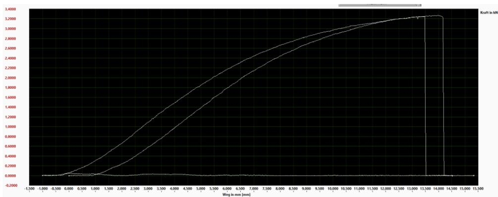
**Ergebnis: Kleinste Bruchkraft= 3,2kN, Einmal Seil aus Schraubterminal, einmal aus Augterminal gezogen.**
