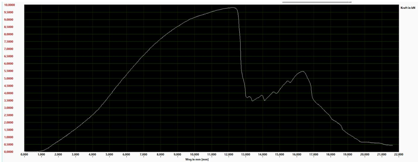
**Ergebnis: Schrauben aus Holz gezogen bei 9,8kN. Decksplatte wenig verbogen.**
