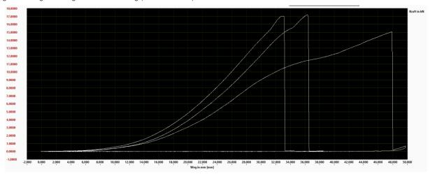
Ergebnis: Bruchlast bei min. 15kN, MBK von 21,66kN nicht überschritten. Drahtseil in der Seilklemme durchtrennt. Im Kraftbereich von ca. 10kN tritt eine Verformung der Seilspannklemme ein, die sich nicht negativ auf die zwei weiteren Versuche auswirkt.
