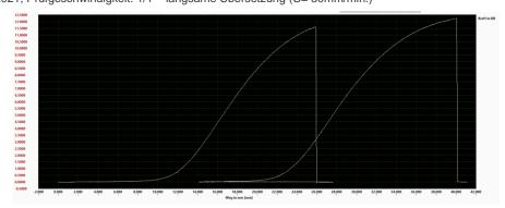
Ergebnis: Kleinste Bruchkraft 11,5kN. Zweimal Seilbruch hinter der Klemme.
