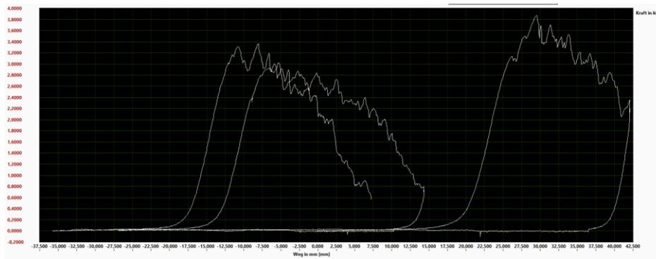
**Ergebnis: Kleinste Bruchkraft ca. 2,8kN = ca. 285kg, Nutzlast max. 71kg bei Sicherheitsfaktor 4**
