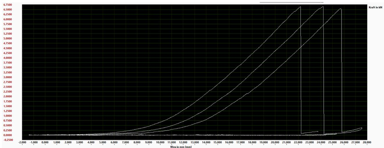
**Ergebnis: Bruchlast bei min. 6,5kN, MBK von 9,63kN nicht überschritten. Drahtseil in der Seilklemme durchtrennt.**
