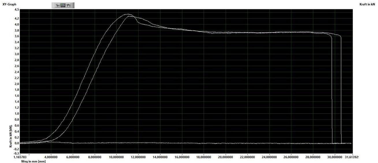
**Ergebnis: Aufbiegen des Hakens bei 3,5kN, Nutzlast max. 71kg bei fünffachem Sicherheitsfaktor**
