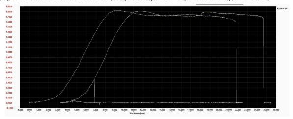
Ergebnis: Aufbiegen des Hakens bei 1,3kN, Nutzlast max. 26kg bei fünffachem Sicherheitsfaktor
