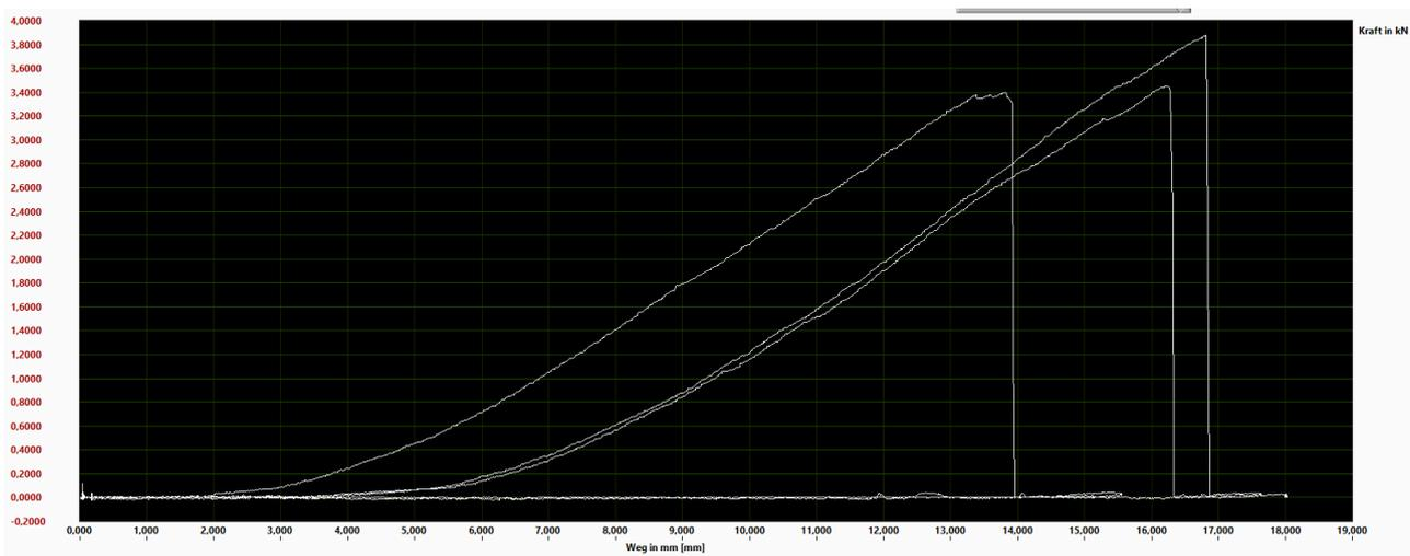
**Ergebnis: Bruchlast bei min. 3,3kN, MBK von 4,75kN nicht überschritten. Drahtseil in der Seilklemme durchtrennt.**
