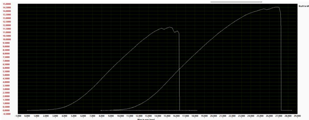
**Ergebnis: Kleinste Bruchkraft bei 11,5kN. Zweimal Seil aus Klemme gezogen.**
