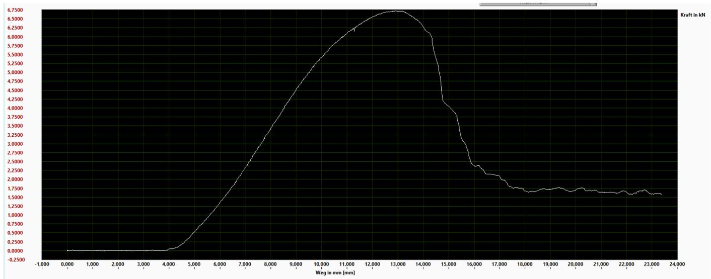
**Ergebnis: Schraube aus Holz gezogen bei 6,7kN. Mastplatte wenig verbogen.**
