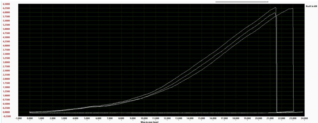
**Ergebnis: Bruch des Drahtseils innerhalb der Klemme bei min. 5,8kN, MBK des Drahtseils von 6,39kN nicht erreicht. Nutzlast max. 118kg bei fünffachem Sicherheitsfaktor**
