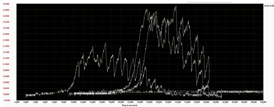
**Ergebnis:** Durch Eiformklemme 2mm rutschendes Drahtseil bei 0,14kN, max. Nutzlast bei 3-fachem Sicherheitsfaktor für Eiformklemme 2mm = 4kg.
