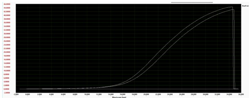
**Ergebnis: Kleinste Bruchkraft 42,6kN. Zweimal Seilbruch hinter der Klemme.**
