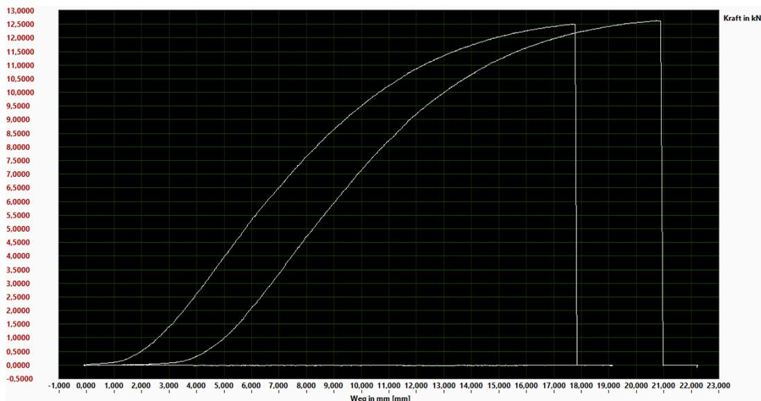
**Ergebnis:** Zweimal Seilbruch am Pressklemmenausgang bei min. 12,5kN. MBK in Höhe von 9,09kN überschritten. Nutzlast bei fünffachem Sicherheitsfaktor: 160kg.
