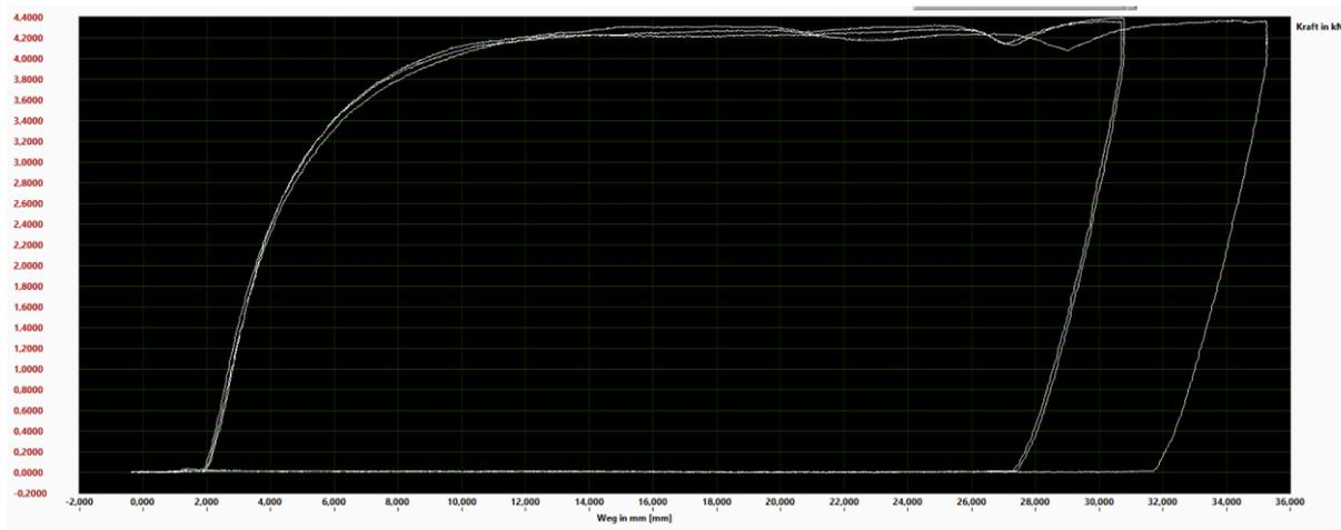
**Ergebnis: S Haken biegt bei 3,0kN auf. Max. Nutzlast 60kg**
